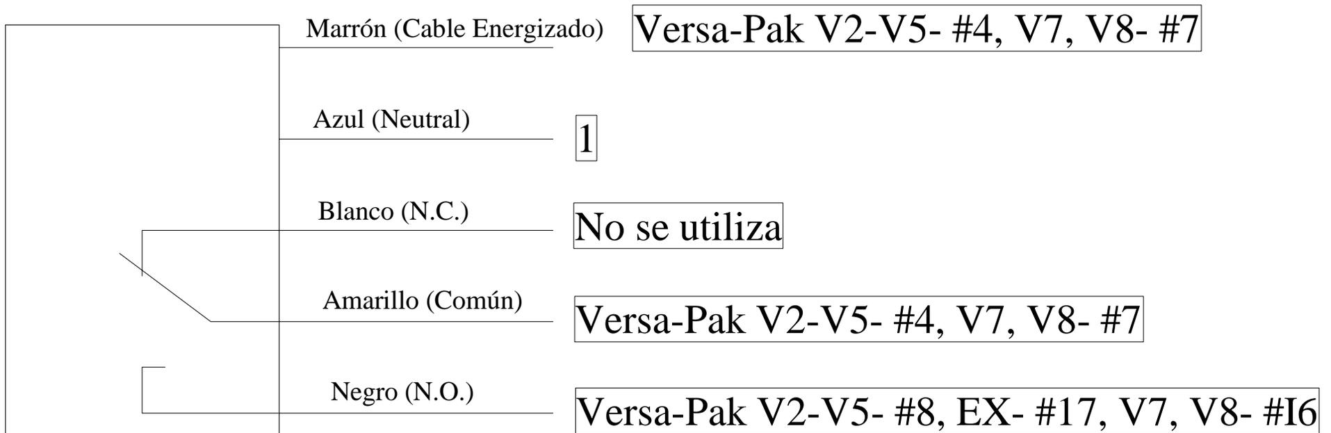
Nota: A diferencia de nuestros otros ojos, esta fococélula utiliza un reflector. El rango es de 6" a 20'. Además, esta fococélula debe estar en "D/O". Para cambiar de L/O a D/O, abra esta la tapa y accione el interruptor.
